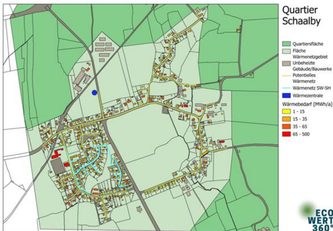
Abbildung 4-21: Geplantes Wärmenetz in Abschnitten
